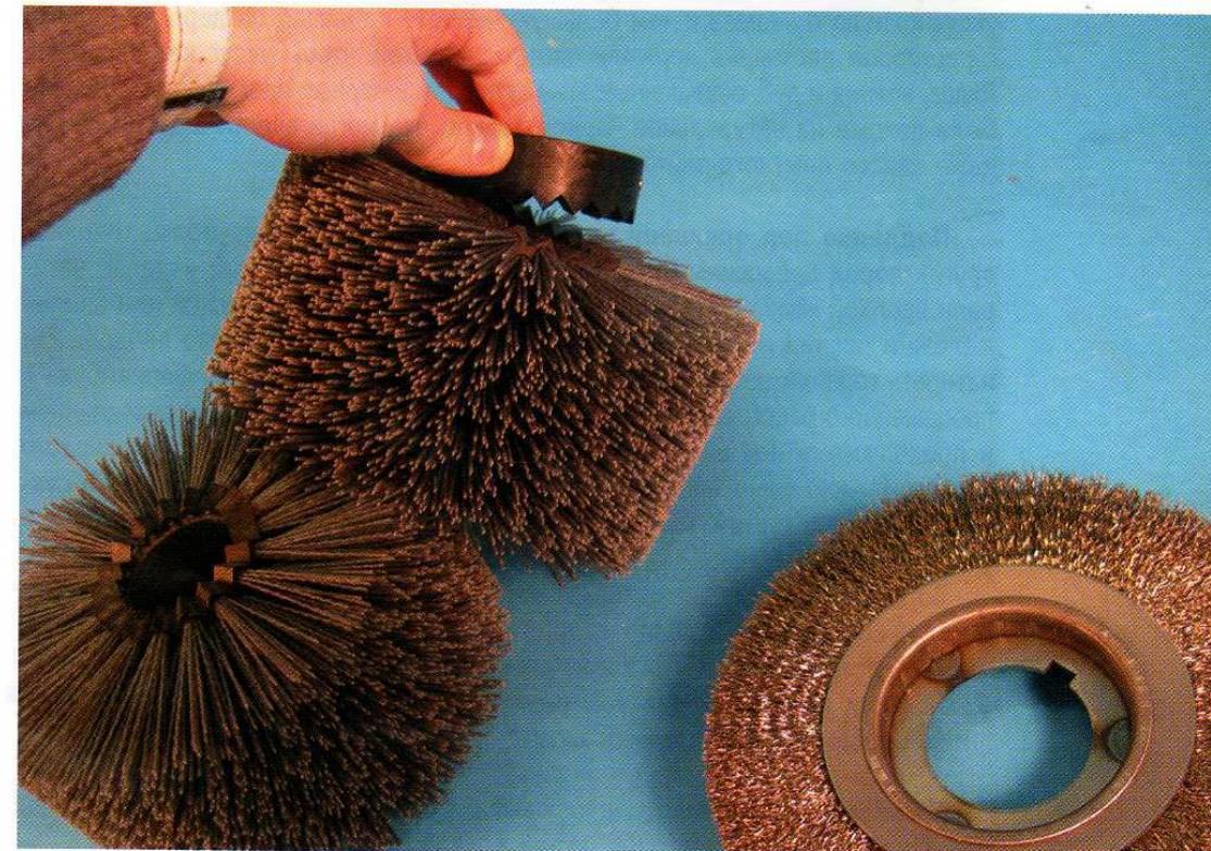
электроинструменты заменяют станками. Так поступают и для повышения производительности. Щетки этих станков по конструкции бывают цилиндрическими, дисковыми, торцевыми и концевыми.
